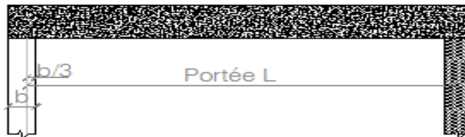
fig29: poutre sur appareils d'appuis
