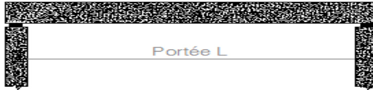
fig28: poutre sur appareils d'appuis
