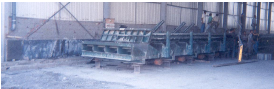
Photo19: Système d'étuvage des éléments de façade du Stade Radès
